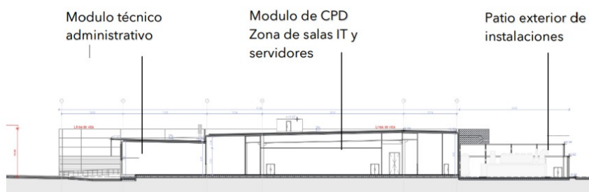
Sección y distribución del edificio de datos
